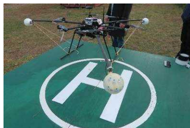
図2 マイクロホンアレイを搭載したドローン
