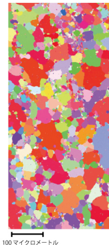
図1 衝撃破壊前の純アルミニウム箔の金属組織図 結晶粒のカラーマッピング(色は結晶構造の向きに対応)。
