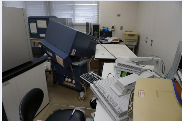
セルアナライザー本体が作業台から落ちて床置部分のタンク類の上に落下（修理不能）
